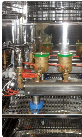
PPS 수도미터 동파방지 테스트 과정
