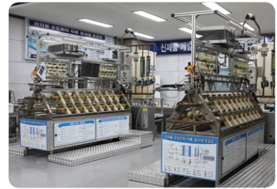
전자동 수도미터 시험, 1.6(100~200배수)검사대 독일 제너사(15~50mm)
