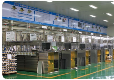
전자동 수도미터 시험, 1.6(100~200배수)검사대 계량기능공사(15~50mm)
