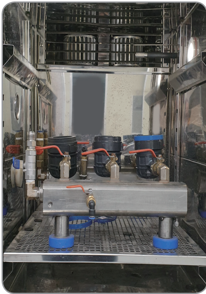
PPS 수도미터 동파방지 테스트 과정
